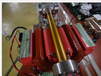
4. 電磁石半割後のビームパイプ設置
