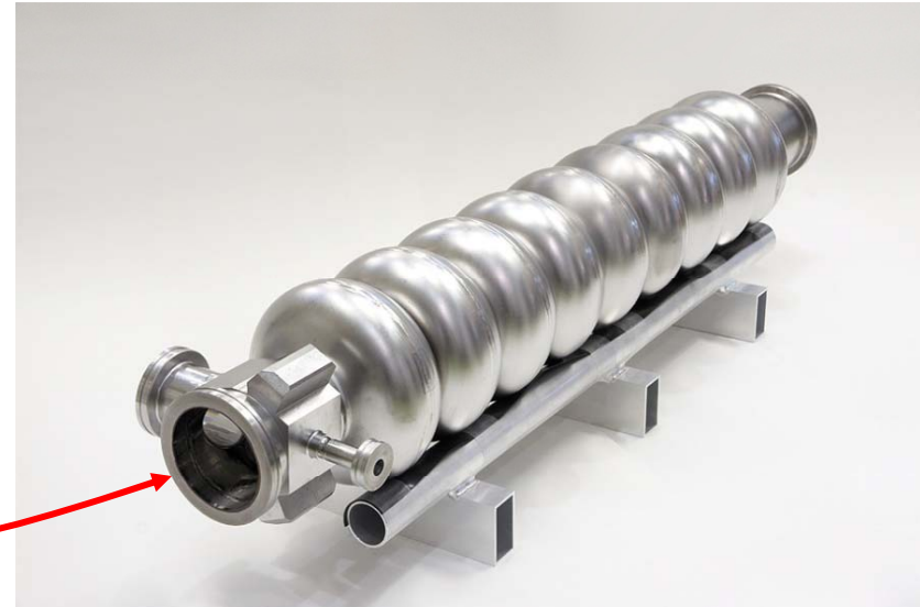
ERL主加速器用超伝導空洞
