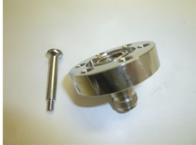
Type-0 (i.c: Kovar, o.c: Kovar)
