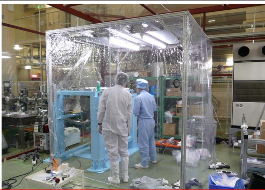
仮設クリーンブース内で電子銃Chamberの取外し作業を行う。
