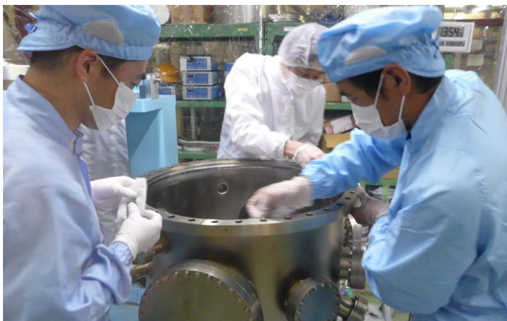
メタルOリング (Uタイトシール) を交換。新しいシール材を乗せる前にシール箇所に残ったアルミを軽く磨いて落とし、ベンコットで十分に拭き取る作業。
