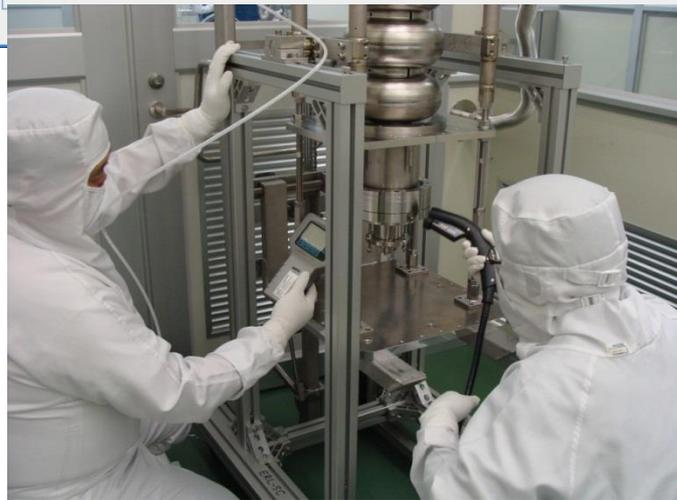
・20MV/mでX-ray traceが観測されていなかったが、フランジ交換作業後、10個近くのemitterが観測されるようになった。
