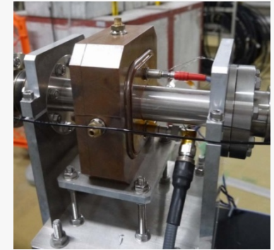
バンチ長測定用 2.6 GHz 偏向空洞
